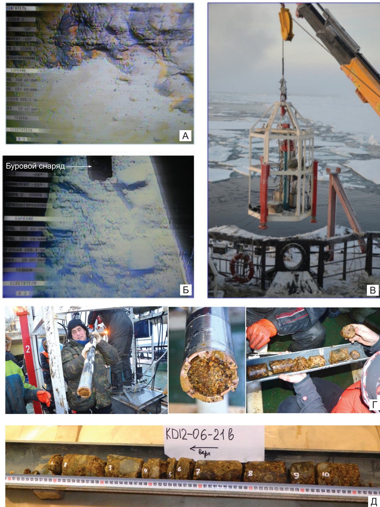
Рис. 24. Глубоководное бурение в юго-западной части хр. Альфа (уч. 06). Глубина скв. KD12-06-21b 2 м, длина керна – 60 см. Керн представлен вулканической брекчией палагонитизированных гиалокластитов трахибазальтового состава: А – обнажение на морском дне в точке бурения KD12-06-21b; Б – колонковое бурение, скв. KD12-06-21b; В – погружение бурового станка с ледокола «Капитан Драницин»; Г, Д – керн палагонитизированной брекчией гиалокластитов трахибазальтового состава
