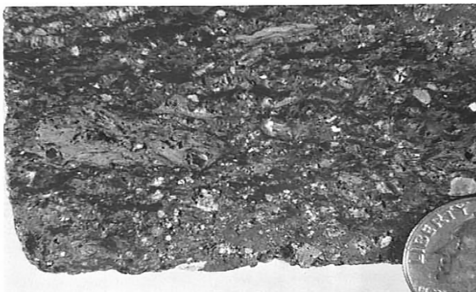
Рис. 40 Фотография фрагмента керна разреза Китового хребта. Трахитовый флюидалный туф с пепловыми лапиллями и фенокристами калиевого полевого шпата. Монета для масштаба.
