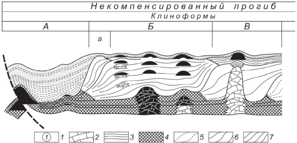
Рис. 2.12. Схема размещения залежей нефти и газа в карбонатных комплексах верхнего девона – турне Волго-Уральской области. По [Мкртчян, 1980]
